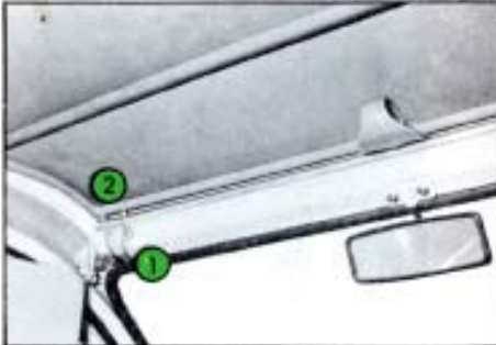
Fig. 24 - Ouverture avant de la capote 1 - Levier de verrouillage 2 - Crochet de maintien
